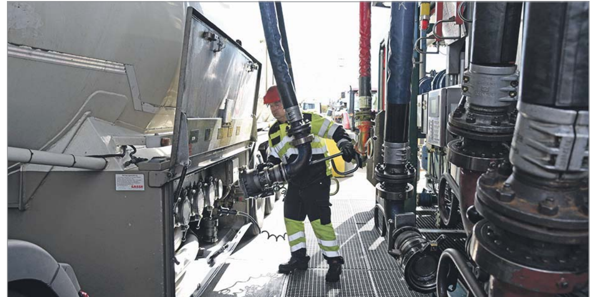
Ankuppeln der Befüllschläuche und Kontrolle über EDV-Terminal.
